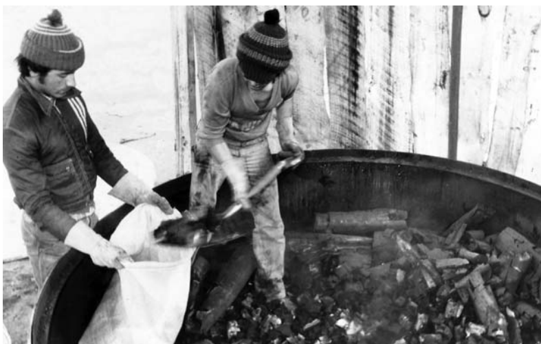
El horno era capaz de producir carbón en solo 20 horas.
