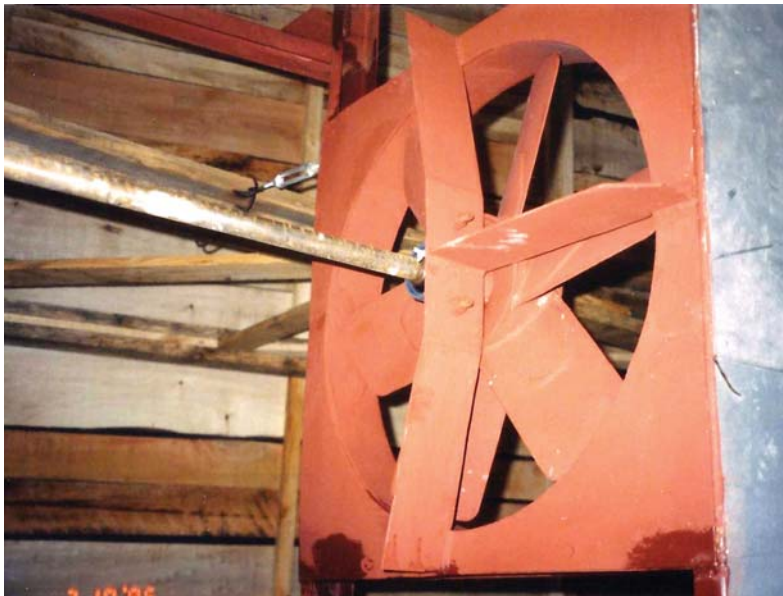
El aire caliente permitía reducir la humedad de las tablas.
